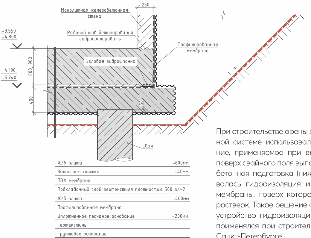
Принципиальный узел гидроизоляции
