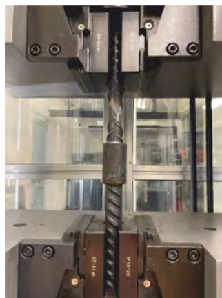
Рис. 4. Испытание муфтового соединения арматуры на растяжение
