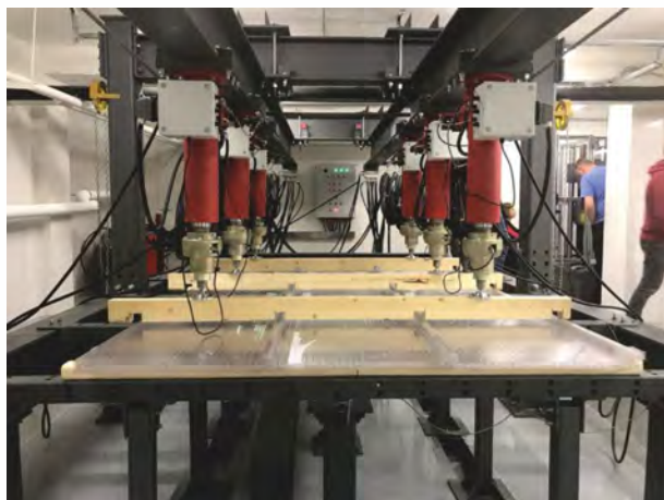
Рис. 6. Испытание большеразмерной панели из сотового поликарбоната
