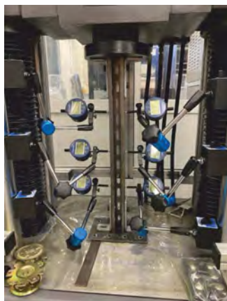
Рис. 2. Испытание стоек фальшпола на сжатие
