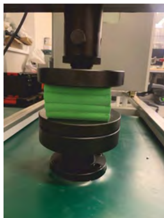
Рис. 3. Испытание виброгасящей прокладки
